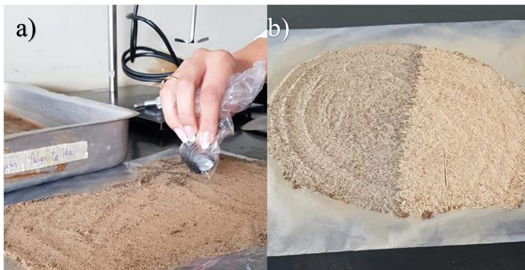
Figura 12 – a) Separação magnética com imã de ferrite; b) comparativo entre material antes da separação (esquerda) e o material depois da separação (direita)
