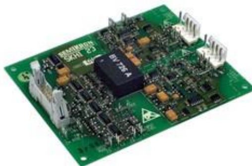
Figura 6-2 - Driver para comando das chaves eletrônicas modelo SKHI 23 SEMIKRON.
