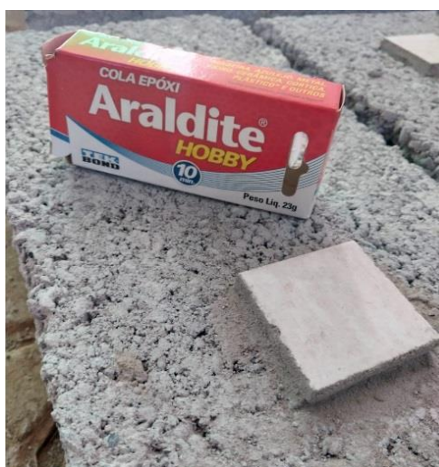
Figura 41 - Adesivo epóxi utilizado na colagem das placas metálicas.
