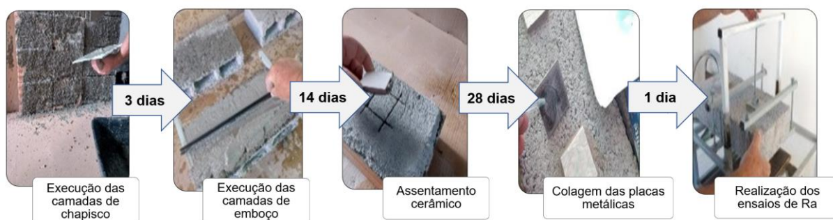
Figura 26 - Períodos de cura das camadas para realização do ensaio de aderência.
