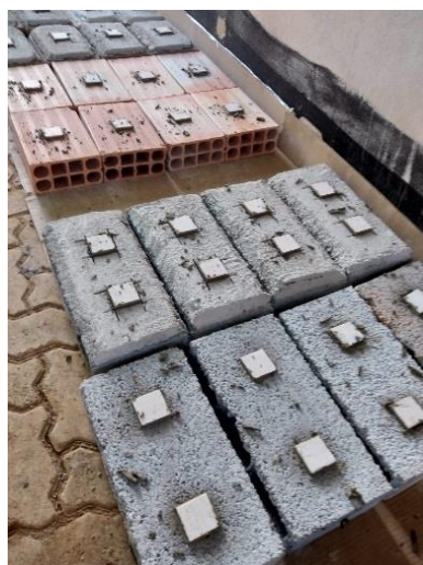
Figura 40 - Corpos de prova armazenados após instalação das placas cerâmicas.
