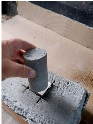
Figura 38 - Posicionamento de um peso sobre a placa cerâmica, recém-instalada no substrato.
