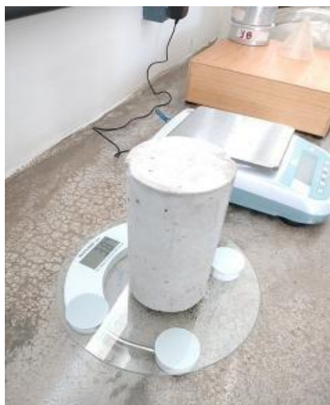
(b) Medida de massa na balança empregada no ensaio
