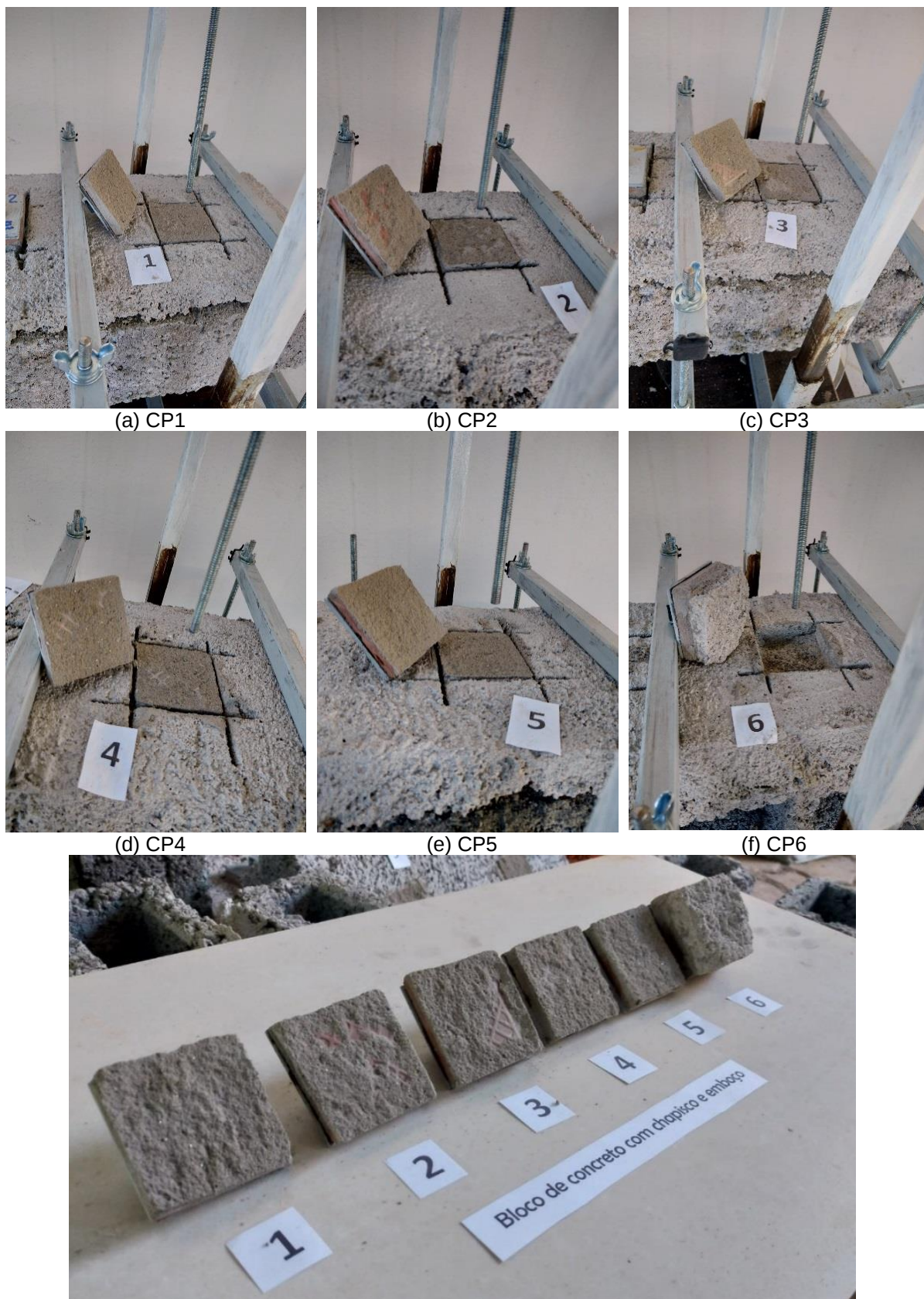
Figura 45 - Placas metálicas após os ensaios para blocos de concreto sem chapisco e emboço.
