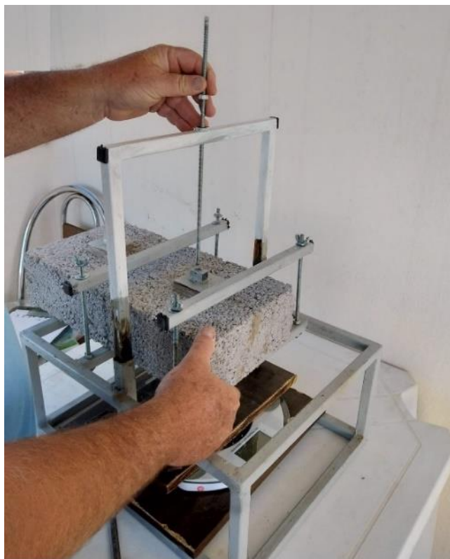
Figura 42 - Colocação do conjunto a ser ensaiado no dispositivo e realização dos ajustes necessários.
