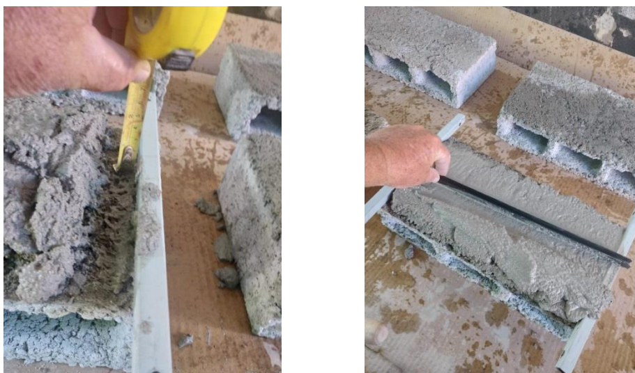
(a) Emboço com espessura de 20 mm
