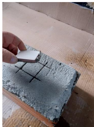
(b) Realização do assentamento da placa cerâmica
