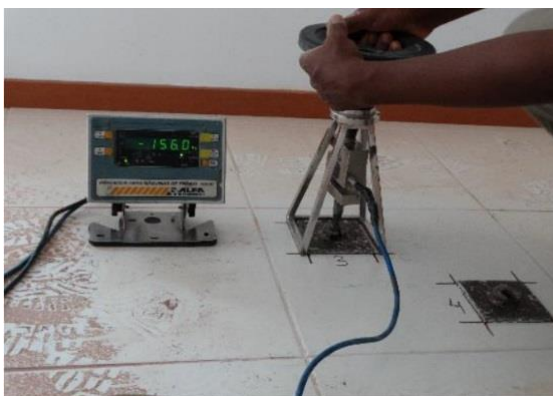
Figura 16 - Procedimento para determinação de resistência de aderência à tração de revestimentos cerâmicos segundo a ABNT NBR 13754 (1996).
