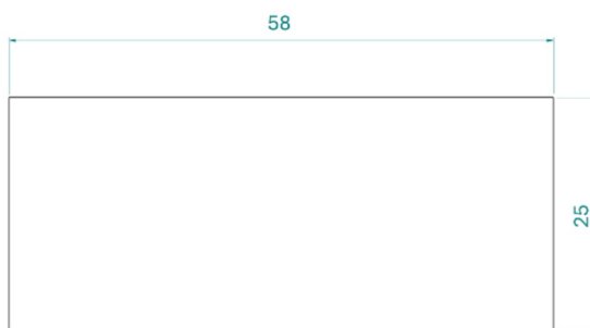
Figura 22 - Representação esquemática da geometria dos CPs (espessura = 0,8mm) utilizados no ensaio de PSD.
