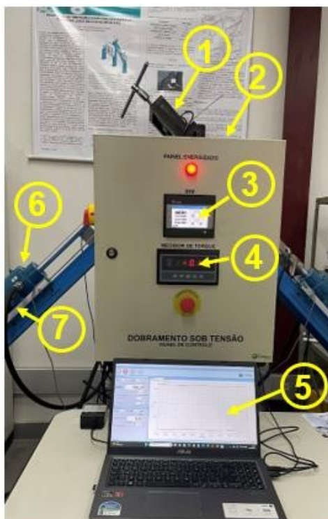
Figura 33 - Tribossimulador utilizado: (1) dispositivo de matriz plana; (2) painel de controle; (3) interface homem-máquina; (4) sensor de torque; (5) computador com software de aplicação; (6) cilindro hidráulico; (7) sensor de posição LVDT.
