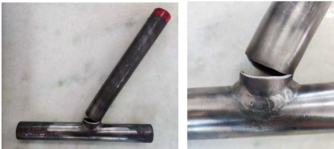
Figura 5.9 – Resultado do Ensaio de Flexão – Corpo de Prova com União em 90°
