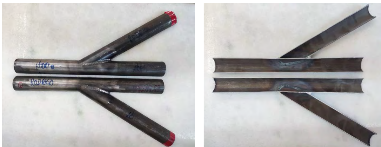
Figura 5.10 – Inspeção Destrutiva (Aspecto externo do cordão e Corte para visualização da penetração da solda) – Corpo de Prova com União em 30°
