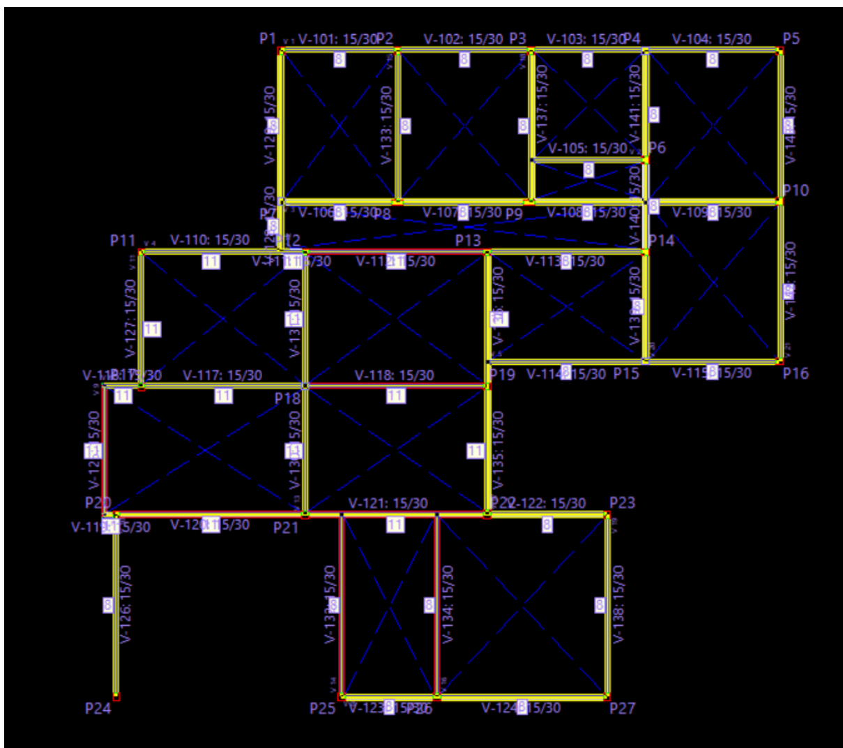
Figura 11 – Lançamento das cargas de alvenaria para o sistema de lajes maciças
