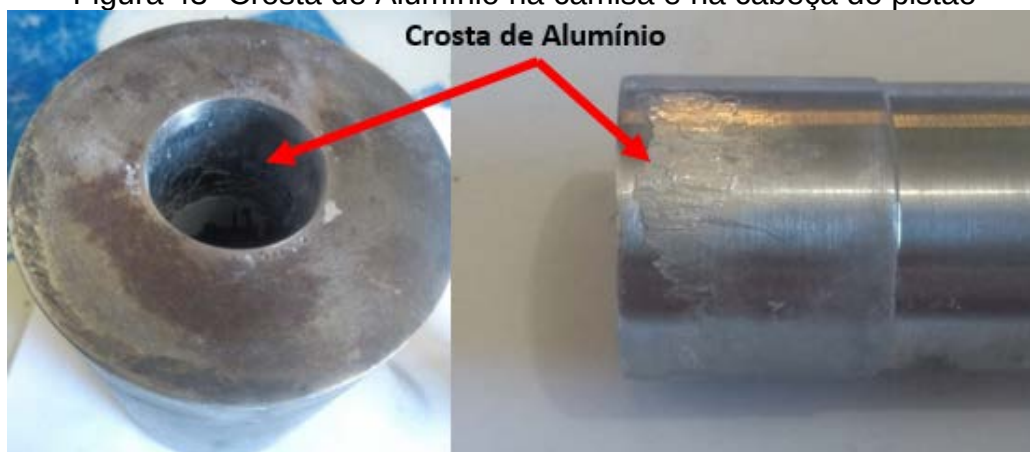
Figura 43- Crosta de Alumínio na camisa e na cabeça do pistão
