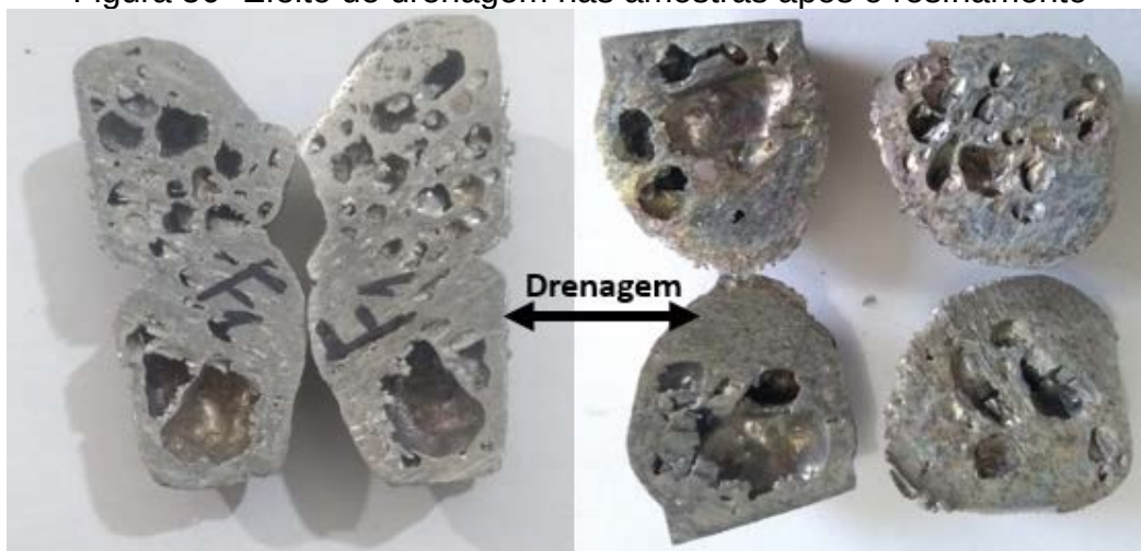
Figura 50- Efeito de drenagem nas amostras após o resfriamento
