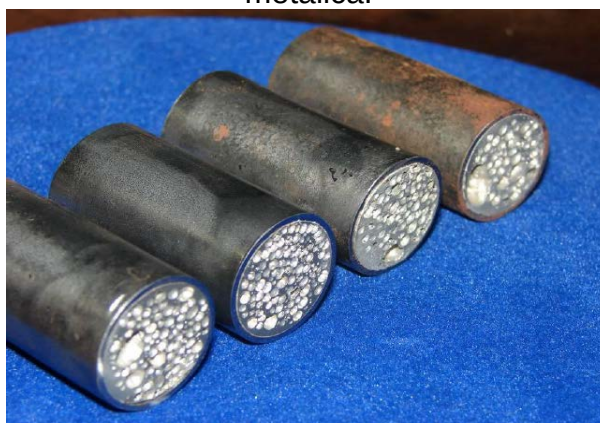
Figura 2- Exemplos de componentes estruturais (tubos) preenchidos com espuma metálica.
