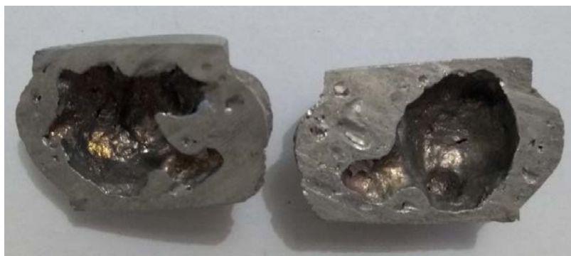
Figura 51- Evidência do fenômeno da coalescência
