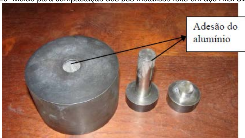
Figura 20- Molde para compactação dos pós metálicos feito em aço AISI 316 trefilado
