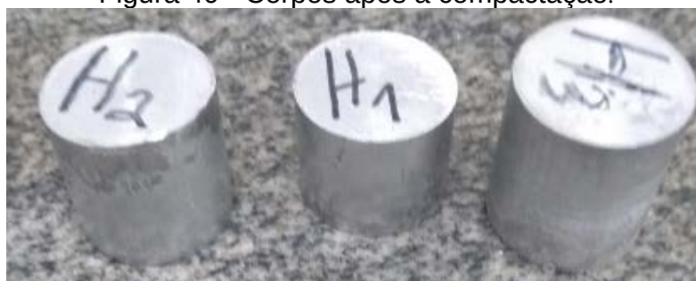
Figura 40 - Corpos após a compactação.
