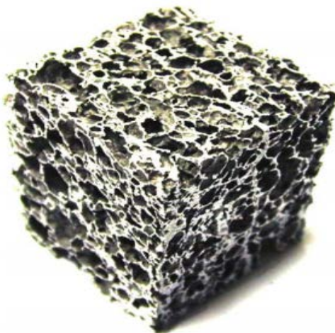
Figura 7- Espuma de liga de alumínio contendo 3% de Si, 2% de Cu e 2% de Mg
