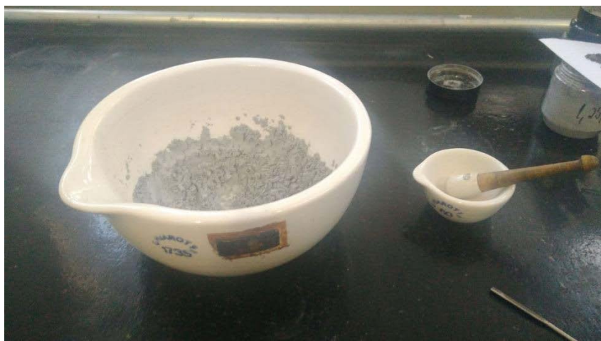
Figura 28- Almofariz para mistura de hidreto de titânio com pó de alumínio
