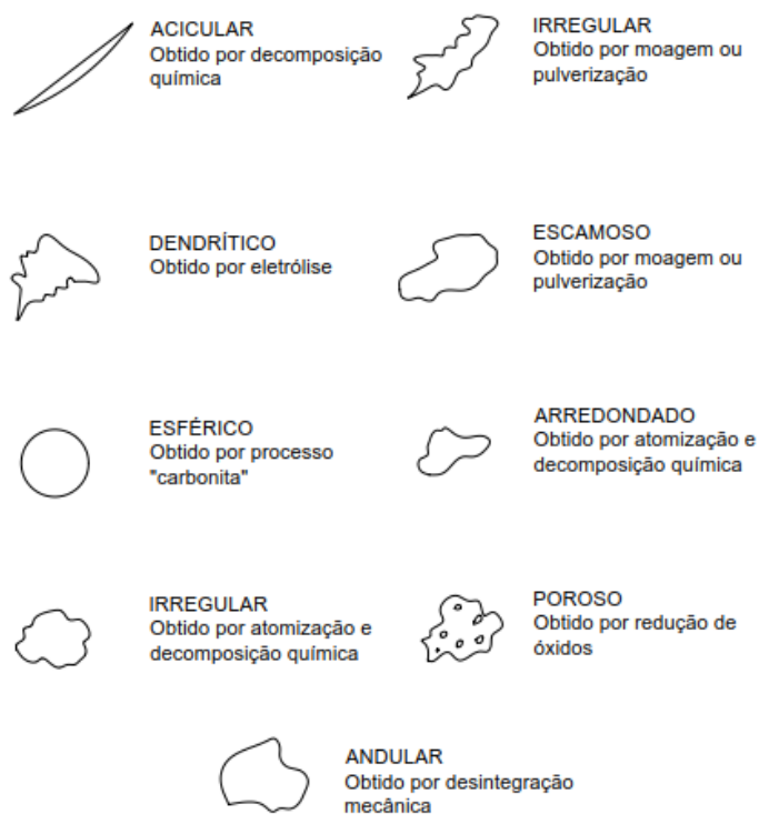
Figura 9- Formas de cada partícula em função da rota de obtenção
