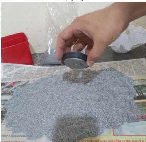
Figura 26- Separação magnética de partículas ferrosas dos cavacos de alumínio ASTM 7075
