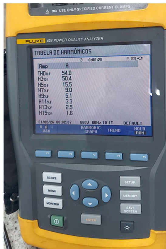
Figura 4.13 – II: Medições dos parâmetros com o analisador FLUKE 434.
