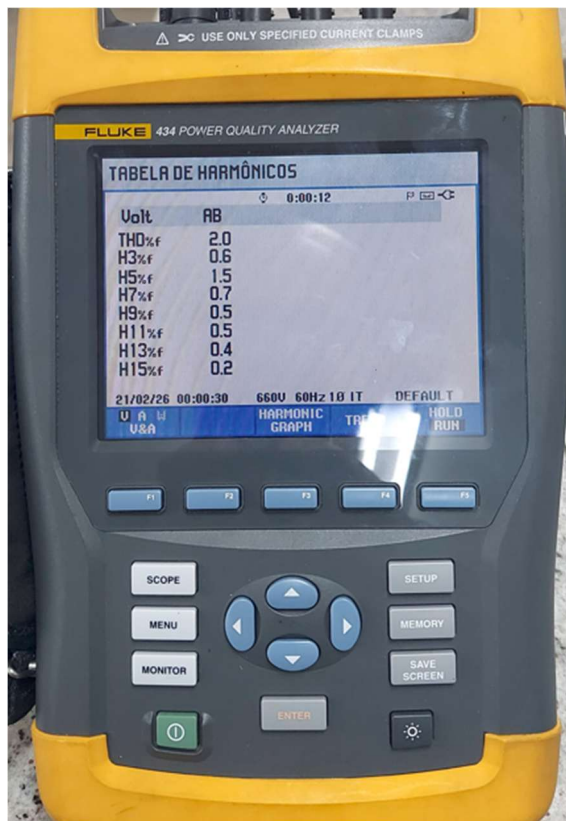
Figura 4.13 – II: Medições dos parâmetros com o analisador FLUKE 434.
