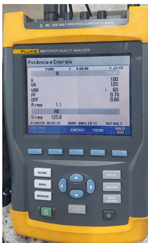
Figura 4.12 – I: Medições dos parâmetros com o analisador FLUKE 434.
