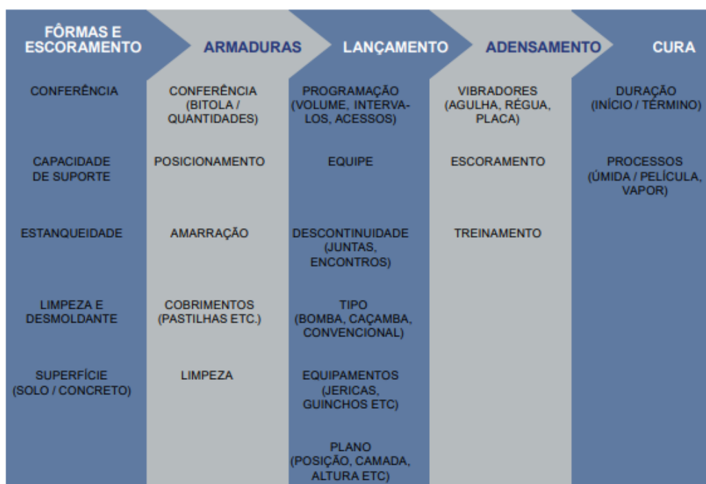
Figura 16: Principais etapas de plano de concretagem.
