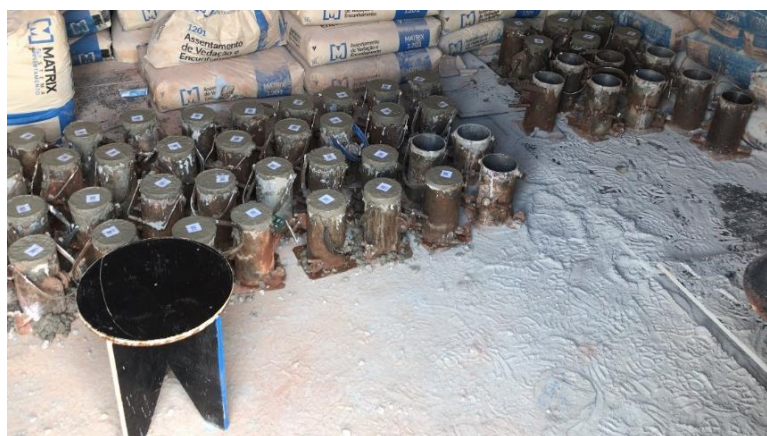
Figura 52: Moldagem de CPs no canteiro de obras.
