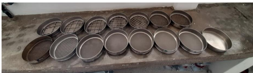
(b) Sequência de peneiras de 75 mm até 0,075 mm
