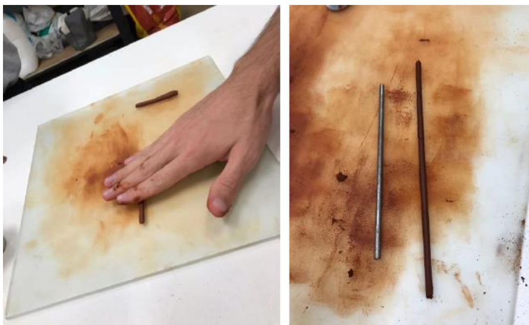
Figura 13: Execução do ensaio do Limite de Plasticidade
