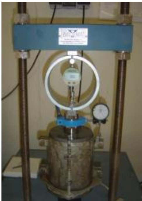
Figura 7: Execução do ensaio CBR em laboratório
