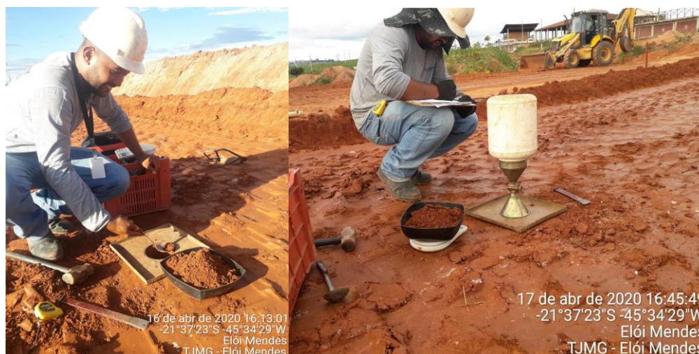
Figura 41: Execução em campo do ensaio de massa específica aparente.
