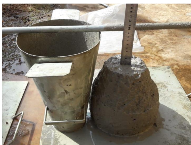
(b) Obtenção de abatimento do tronco de cone.
