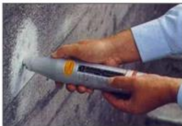
Figura 22: Ensaio de dureza superficial pelo método do esclerômetro.
