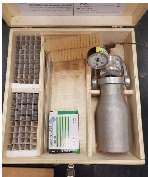
Figura 5: Aparelho Speedy para determinação de umidade.
