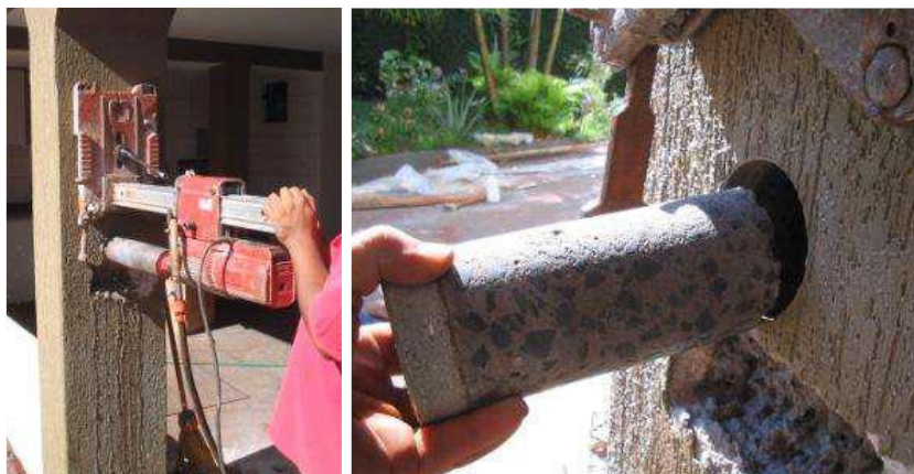
Figura 21: Ensaio de extração de testemunhos.
