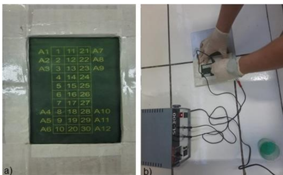
Figura 12 - a) Matriz e b) Equipamento para marcação das amostras.
