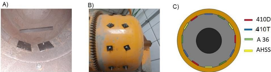
Figura 16 - Fixação das amostras na betoneira: A) Vista interna, B) Vista externa e C) Vista transversal (esquemático).
