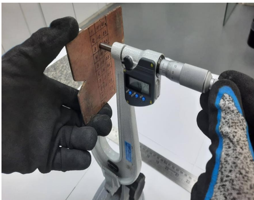
Figura 17 - Medição da espessura.
