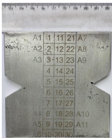
Figura 13 - Amostra A1 de aço inoxidável 410D, marcada com a grade.
