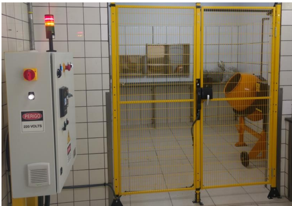
Figura 8 – Vista do laboratório com a betoneira adaptada para experimentos de desgaste.
