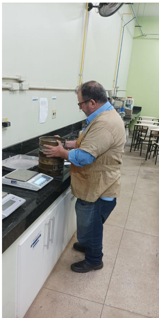
Figura 33- Ensaio de granulometria de material filtrante: brita (Laboratório Pavimentação do Departamento de Engenharia de Transportes _CEFETMG-Campus Nova Suíça).
