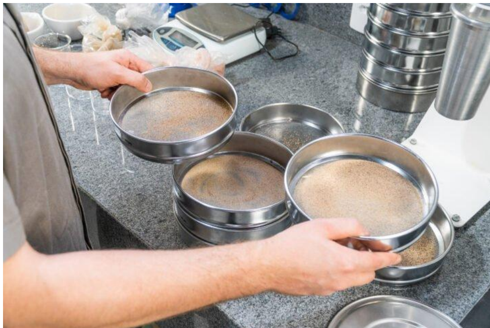
Figura 32- Ensaio de granulometria de solo (Laboratório Pavimentação do Departamento de Engenharia de Transportes _CEFETMG-Campus Nova Suíça).
