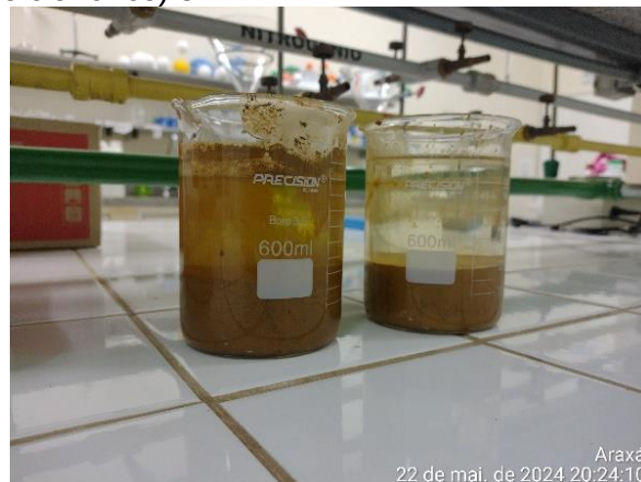
Figura 15: Tratamento do rejeito com HCl (ácido clorídrico) 3M.
