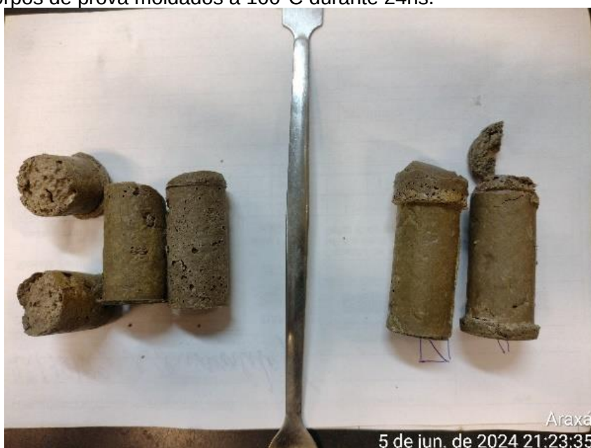
Figura 25: Corpos de prova moldados a 100°C durante 24hs.
