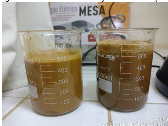
Figura 15: Tratamento do rejeito com HCl (ácido clorídrico) 3M.
