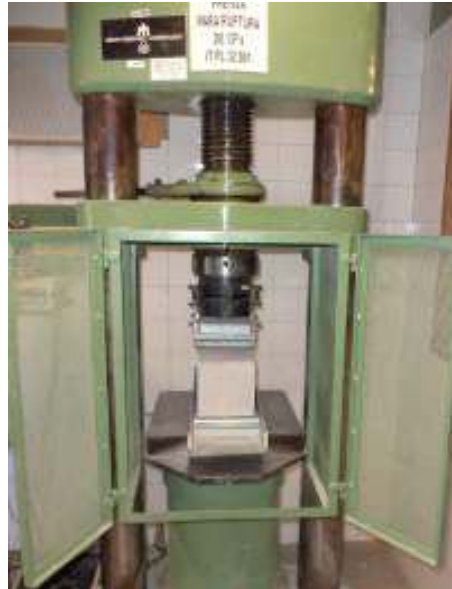
Figura 10 – Foto do ensaio de resistência a tração no concreto
