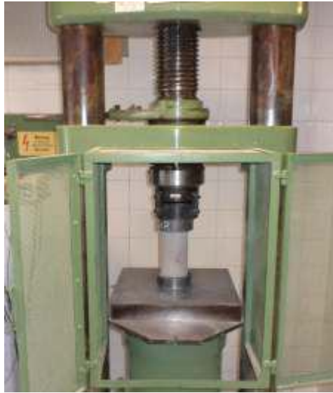
Figura 9 – Foto do ensaio de resistência a compressão no concreto
