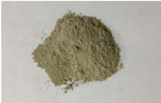
Cimento CP V – ARI + Argila calcinada B (b)
