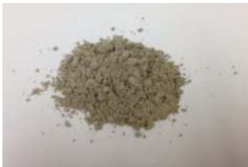
Cimento CP V – ARI + Escória de alto forno (c)
