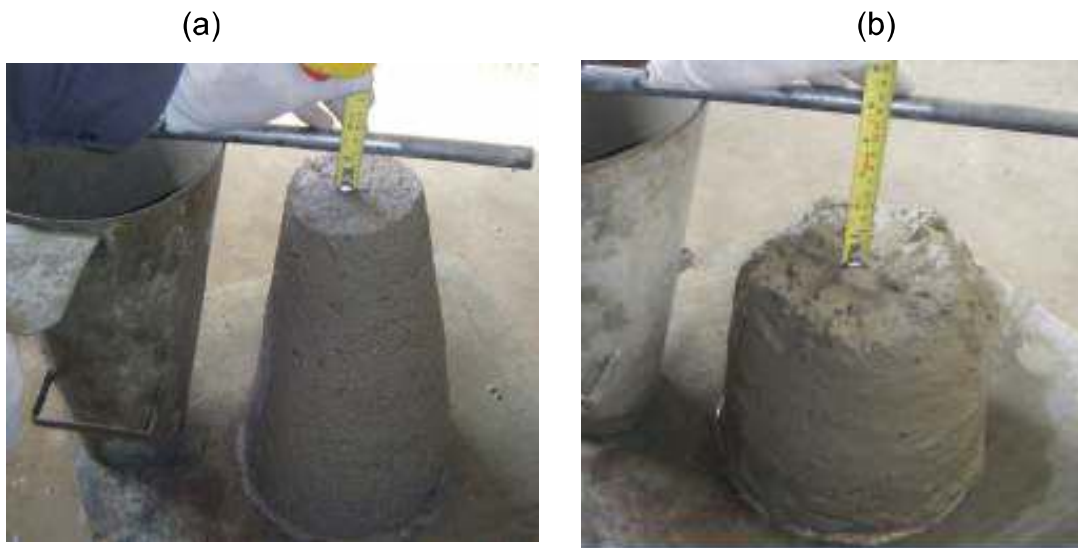
Figura 21 - Foto ilustrativa do ensaio de abatimento de cone do concreto produzido com CP II E (a) e CP IV (b).
