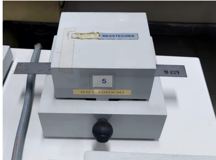
Figura 19 - Quadro SST “ single sheet tester ” para medida de perdas em lâminas individuais
