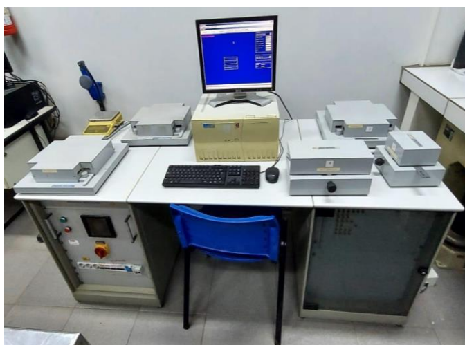
Figura 17 - Histeresímetro Brockhaus Messtechnik modelo MPG 100
