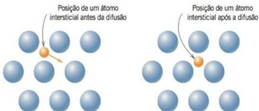
Figura 7 - Difusão intersticial em uma estrutura cristalina
