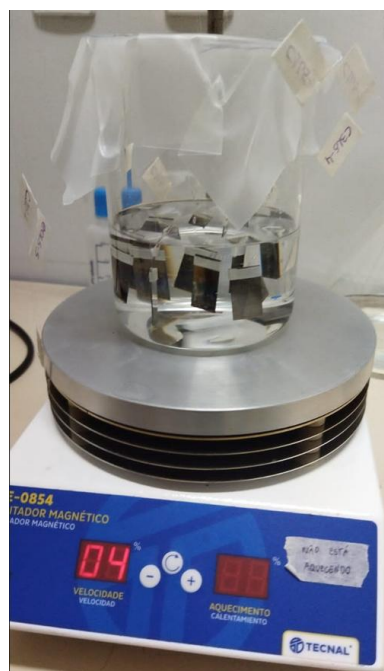
Figura 32: Sistema corrosivo do teste de superfície
