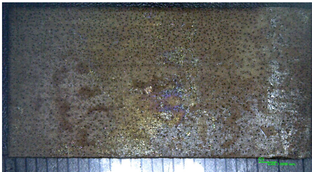
Figura 56: Teste de superfície AISI 304 com filme de \text{TiO}_2 (C0) – 21 dias, solução de \text{HCl} 2,0 \text{ mol L}^{-1}
