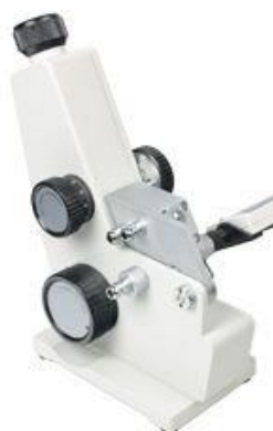
Figura 26: Refratômetro de bancada - usado para índice de refração
