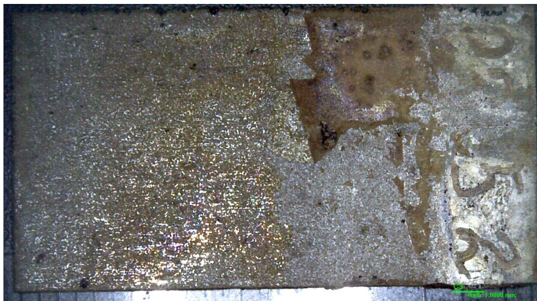
Figura 59: Teste de superfície AISI 304 com filme de \text{TiO}_2 + 30\% \text{Nb}_2\text{O}_5 (C3) – 21 dias, solução de \text{HCl } 2,0 \text{ mol L}^{-1}
