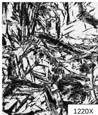
Figura 1: Micrografia da microestrutura da Martensita.
