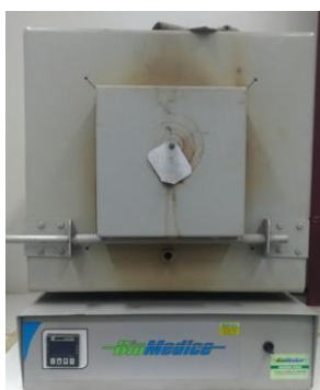
Figura 28: Mufla usada no tratamento térmico dos filmes e pós.
