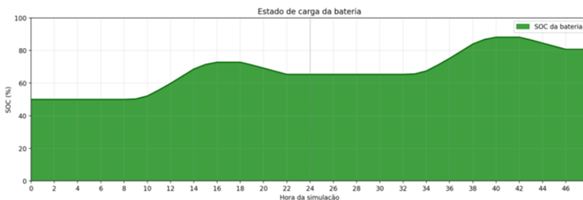
Figura 3 — Variação do estado de carga da bateria (%) ao longo das 48 horas de simulação no cenário conectado
