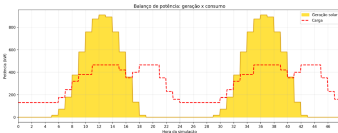
Figura 2 — Balanço de potência entre geração solar e carga ao longo de dois dias no cenário conectado
