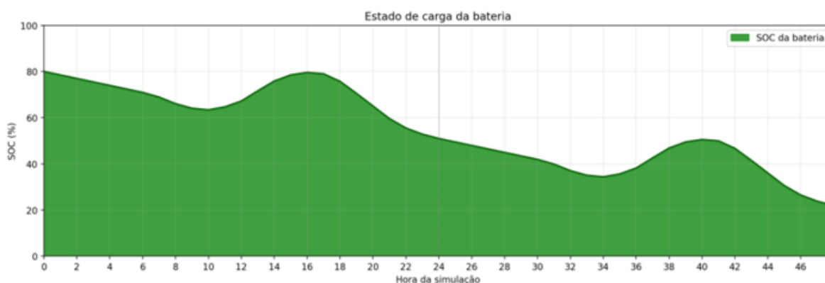
Figura 5 — Variação do estado de carga da bateria (%) ao longo das 48 horas de simulação no cenário ilhado
