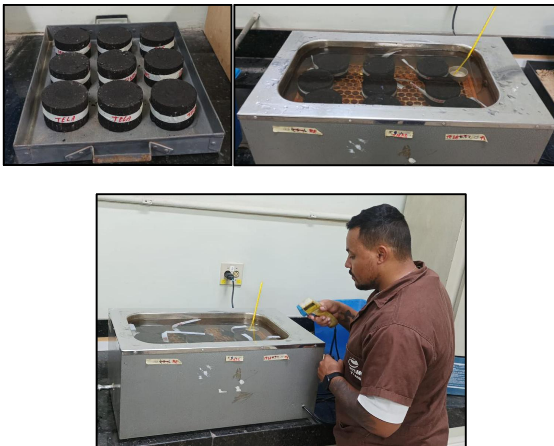
Figura 13 – Alocação e submersão banho Maria a 50°C
