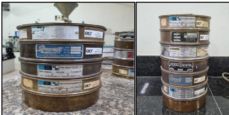
Figura 09 – Instrumentação do ensaio de curva granulométrica
