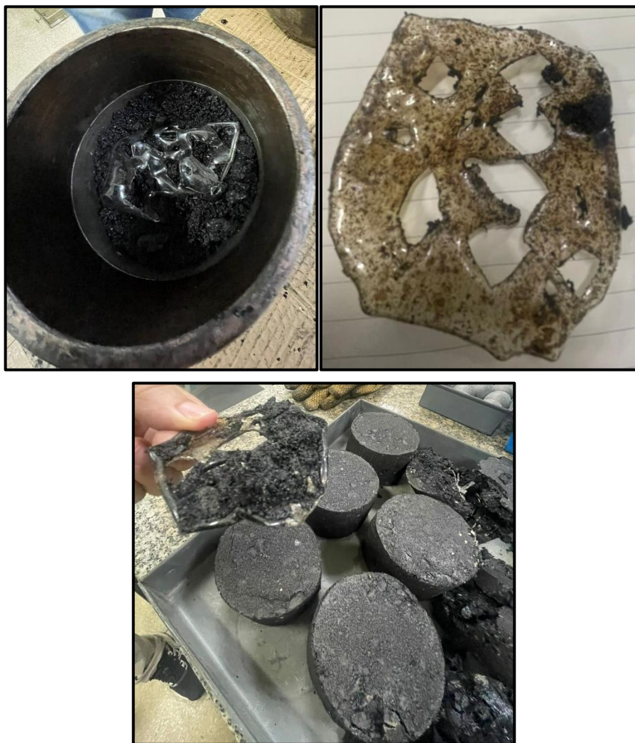
Figura 16 – Resultado visual da compactação dos CPs – 2% de Grelha/10cm
