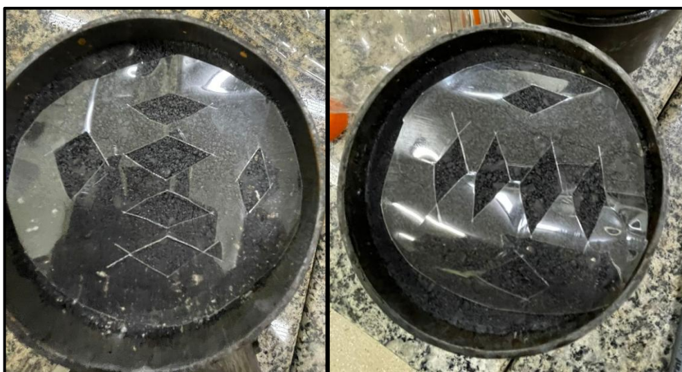
Figura 14 – Grelhas de PET cortadas para aferição da massa (dosagem 2%)
