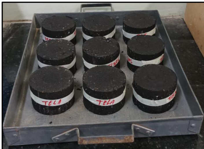
Figura 15 – Homogeneização e identificação dos CPs com grelha
