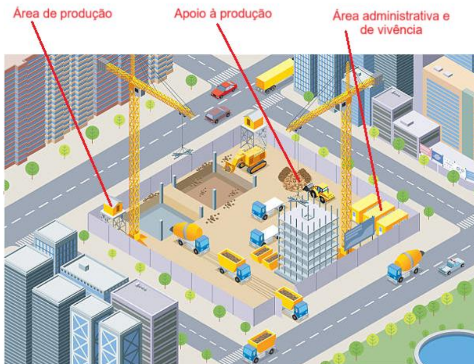
Figura 10: Exemplo de layout de canteiro de obras.
