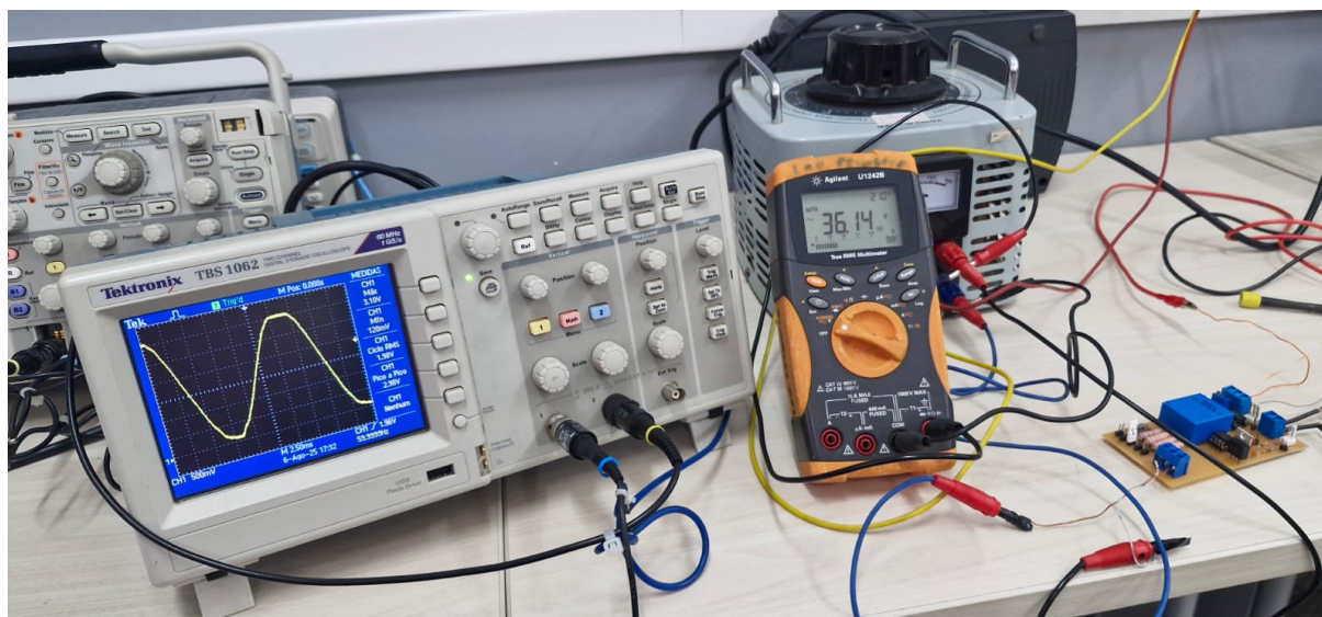
Figura 4.3 – Resposta experimental do sensor de tensão.
