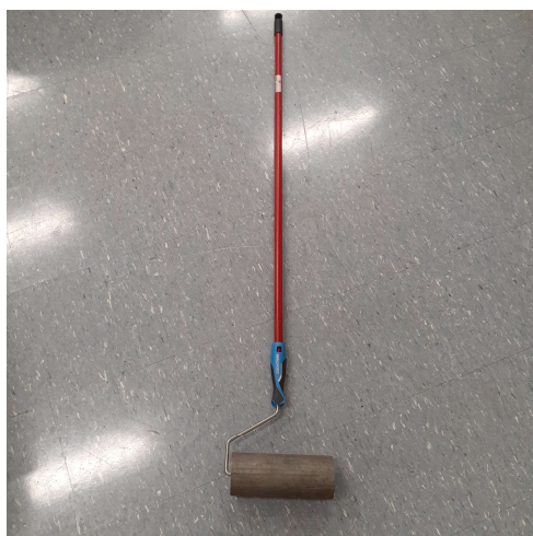
Figura 6.2 - Rolo usado para compactar o solo
