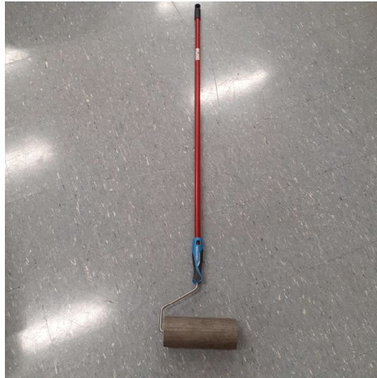
Figura 3.6 - Rolo usado para compactar o solo
