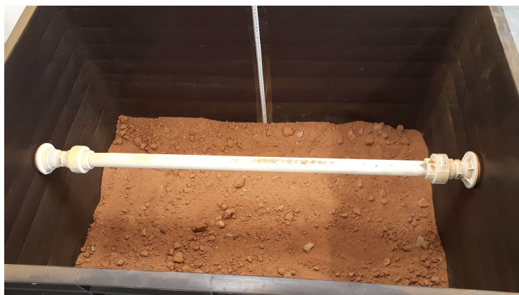
Figura 6.3 - Primeira camada de solo colocada na caixa com detalhe para a fita métrica fixada em uma de suas paredes.
