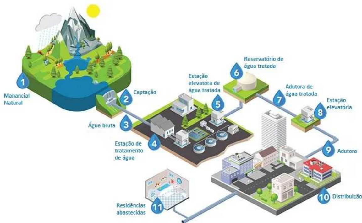
Figura 2.1 - Esquema típico de um sistema de abastecimento de água FONTE: (ALFACOMP, 2019)
