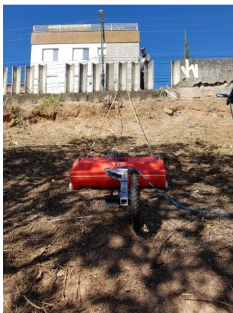
Figura 13: Sistema de movimentação do GPR.
