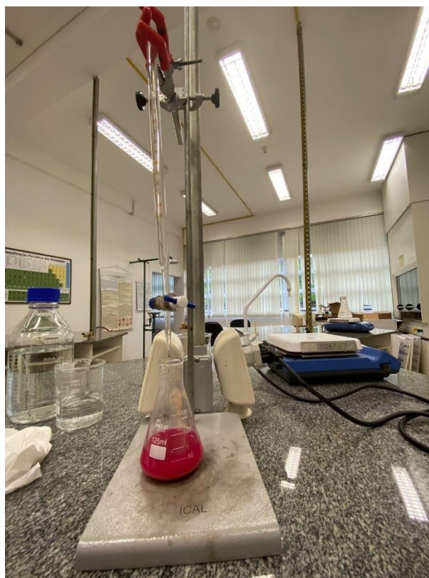
Figura 17 – Titulação das amostras de cinzas solubilizadas com indicador fenolftaleína.
