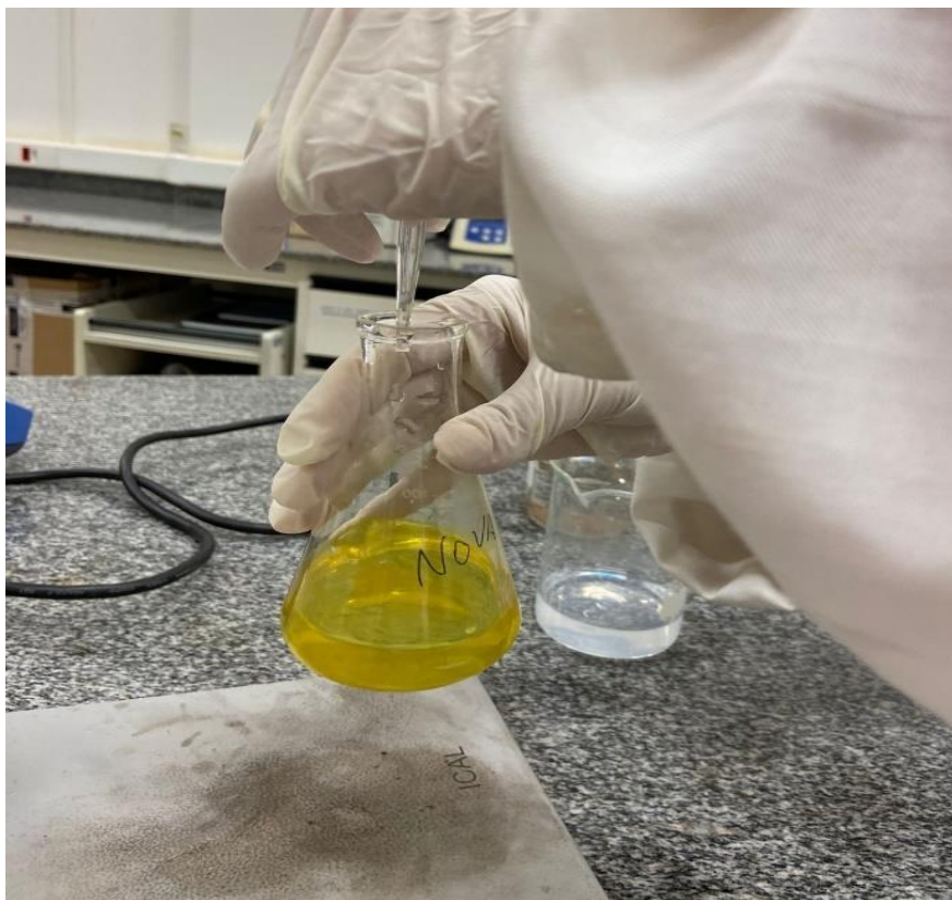
Figura 18 – Titulação das amostras de cinzas solubilizadas com cromato de potássio.
