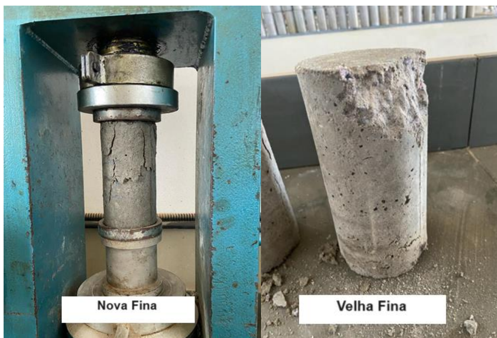
Figura 33– Resistência à compressão dos moldes das cascas finas.
