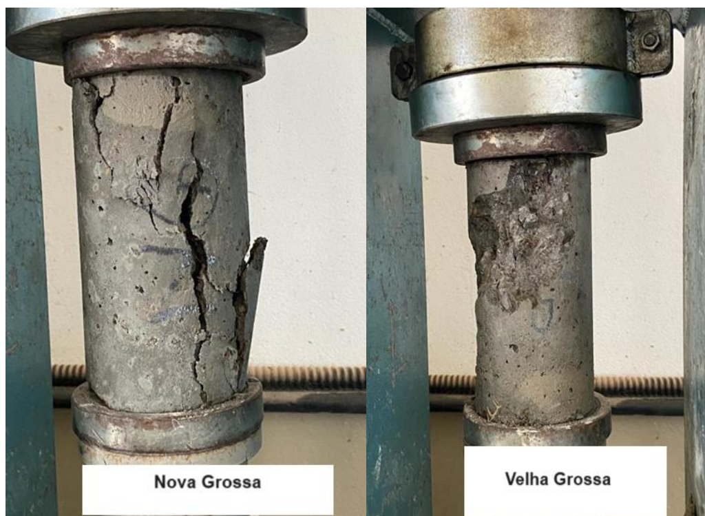
Figura 35– Resistência à compressão dos moldes das cascas grossa.
