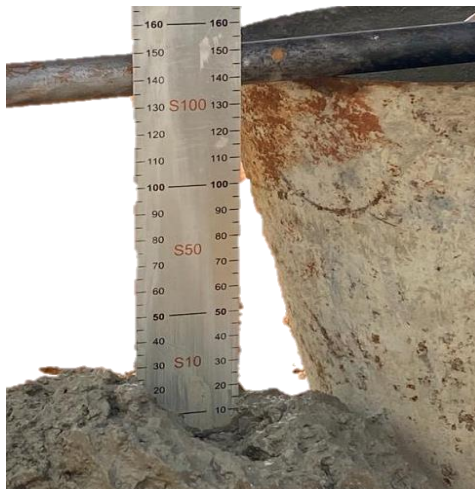
Figura 29– Slump test dos moldes de concreto.
