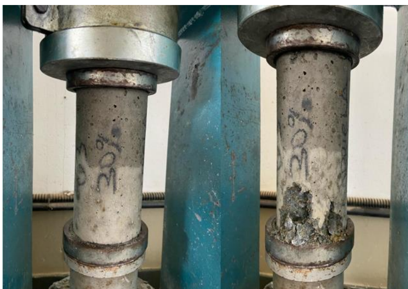
Figura 41 – Resistência à compressão dos corpos de prova com 30% de casca.
