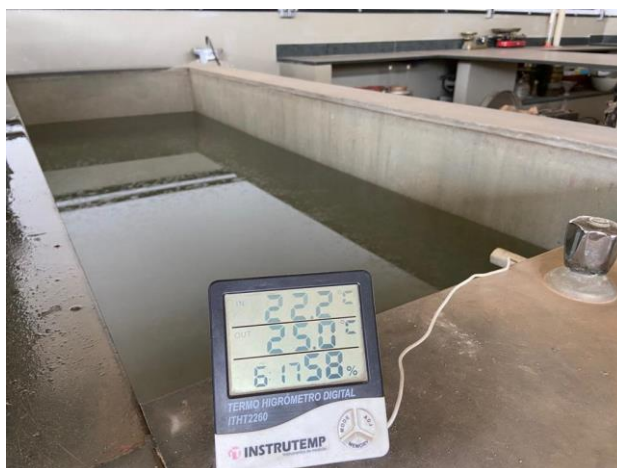
Figura 30– Tanque de cura com os moldes de concreto.
