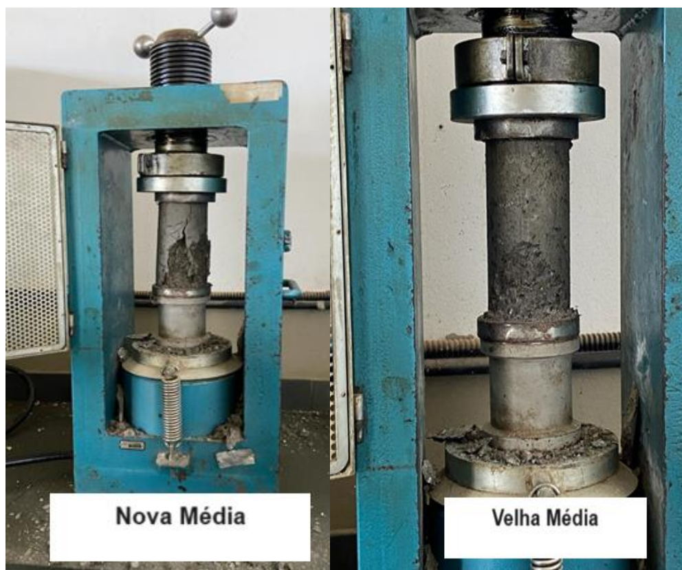
Figura 34– Resistência à compressão dos moldes das cascas média.
