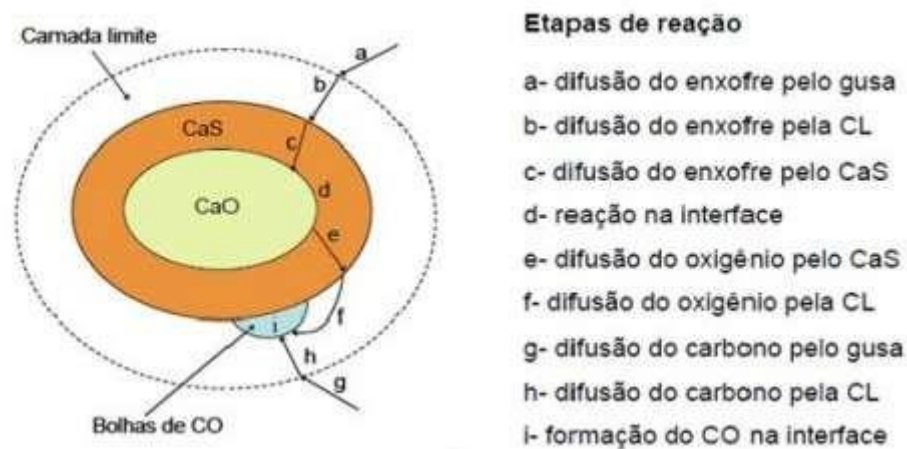
Figura 4: Dessulfuração do gusa através de partículas de cal.
