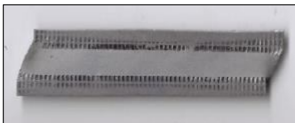
Figura 33 - Amostra retangular para ensaio de cisalhamento planar simples
