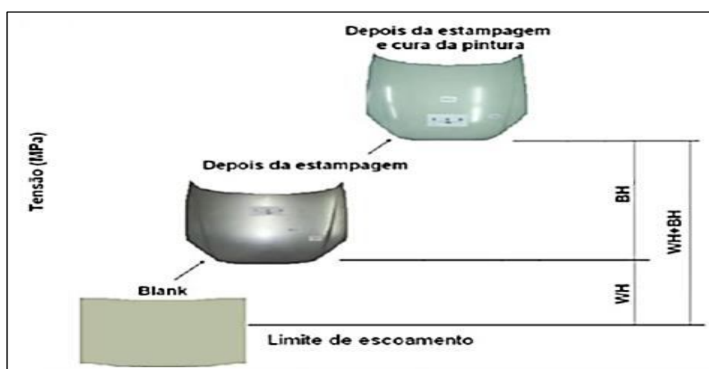
Figura 2 - Aumento na resistência mecânica de um capô automotivo após mecanismos de envelhecimento
