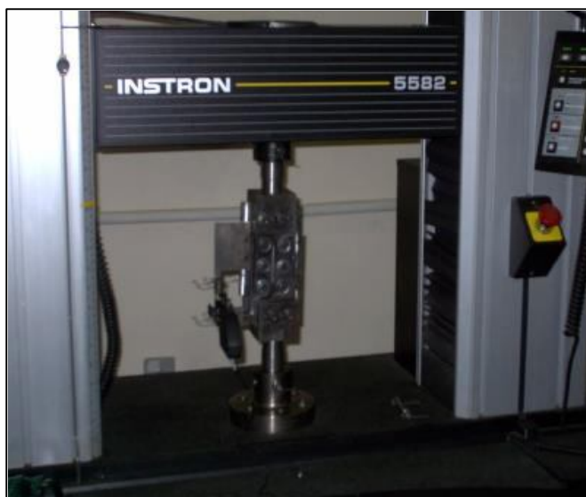
Figura 48 - Máquina universal de ensaios com a garra de cisalhamento montada
