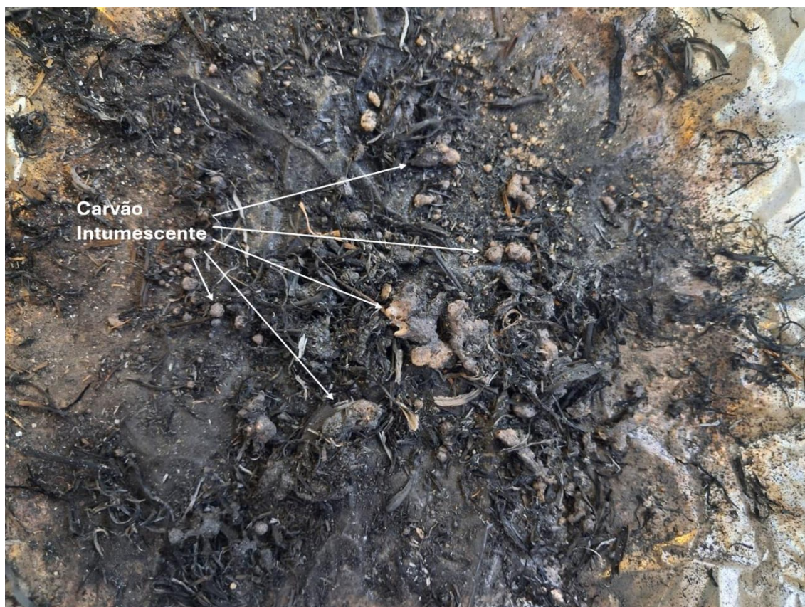
Figura 25 – Resíduo carbonizado após a queima do capim-gordura tratado com retardante de chama (nesta imagem, do teste com PCN200), evidenciando a formação de aglomerados esbranquiçados porosos (carvão intumescente).
