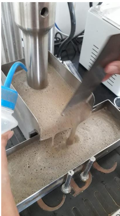
Figura 28 - Flotação (sem deslamagem) utilizando lauril-éter sulfato de sódio com dosagem de 3000 g/t
