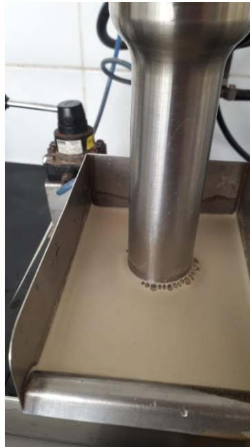
Figura 35 - Deslamagem utilizando lauril-éter sulfato de sódio com dosagem de 3000 g/t.
